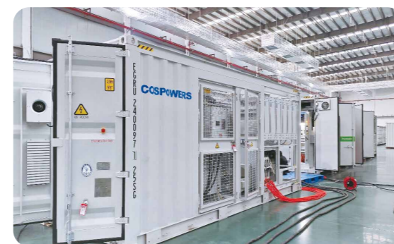
> 拉脱维亚2.5MW/5MWh一体机项目
