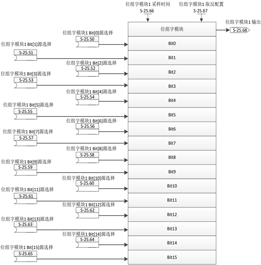
图7-10 位组字模块 1 功能框图
